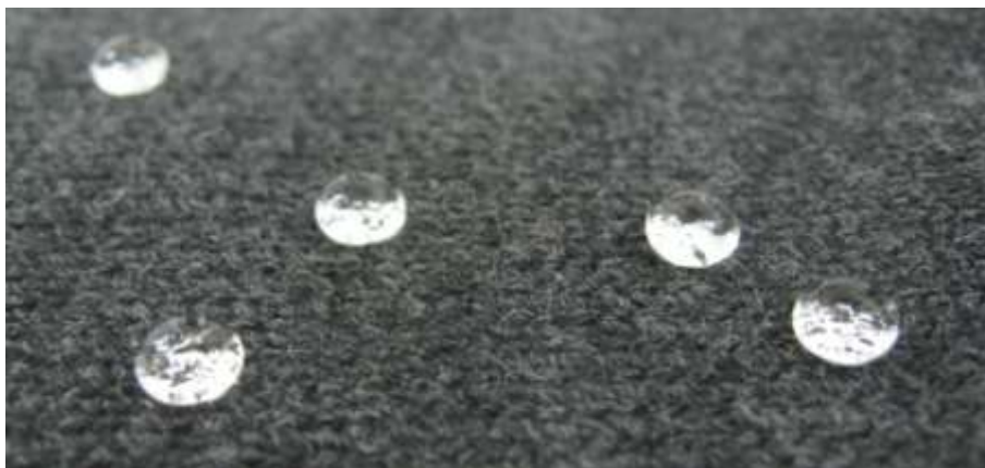
Imagen 5. Género de punto acrílico 100% funcionalizado mediante plasma polimerización, con repelencia a líquidos. Fuente: Elaboración propia.
