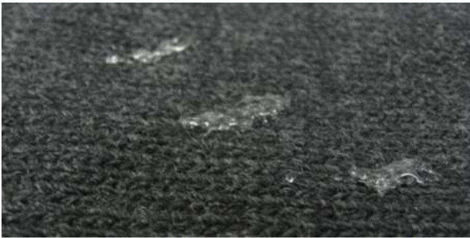
Imagen 4. Género de punto acrílico 100% sin funcionalización mediante plasma polimerización, no repelente a líquidos. Fuente: Elaboración propia.
