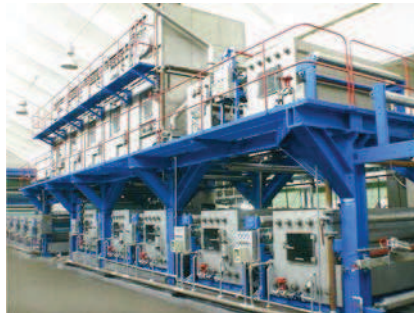
Figura 16. Tren de desencolado, descrudado y blanqueo químico a la continua (pad steam).
