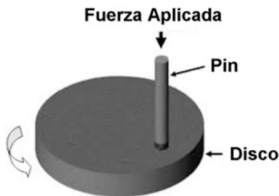
Figura 2. Esquema conceptual de un equipo pin-on-disk
